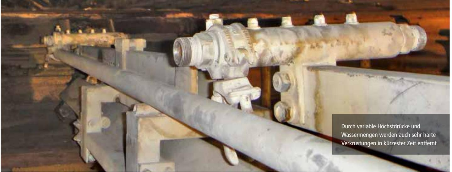
Durch variable Höchstdrücke und Wassermengen werden auch sehr harte Verkrustungen in kürzester Zeit entfernt
