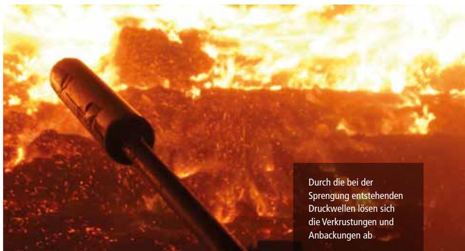
Durch die bei der Sprengung entstehenden Druckwellen lösen sich die Verkrustungen und Anbackungen ab
