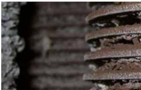
Verunreinigte, mit herkömmlichen Reinigungsmethoden schwer zu reinigende Anlagenteile
